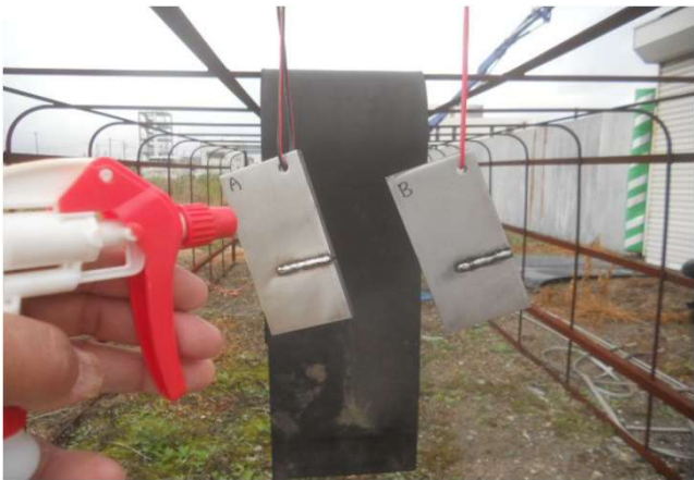
塩カルを定期的に吹き付け。 90日以上経過しても錆の発生認められず
