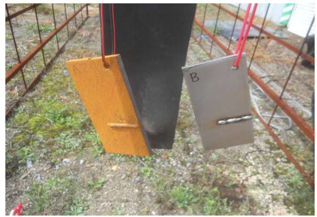
塩カルを定期的に吹き付け。 90日以上経過しても錆の発生認められず
